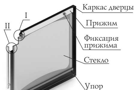
Рисунок 13. Ремонт светопрозрачного экрана дверцы модели «Витра»
