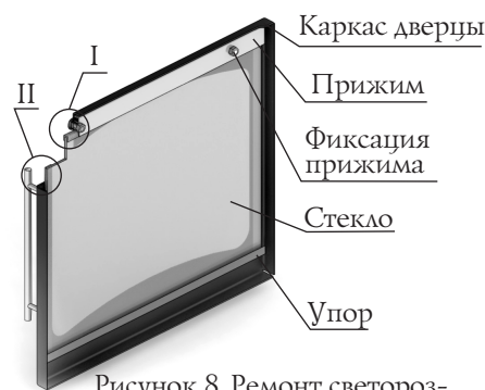
Рисунок 8. Ремонт светорозрачного экрана дверцы модели «Витра»
