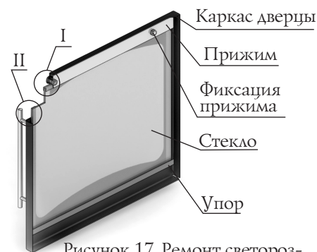
Рисунок 17. Ремонт светорозрачного экрана дверцы модели «Витра»
