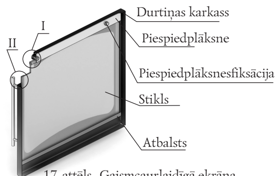
17. attēls. Gaismaurlaidīgā ekrāna stiprināšana «Vitra» modeļa durtiņās
